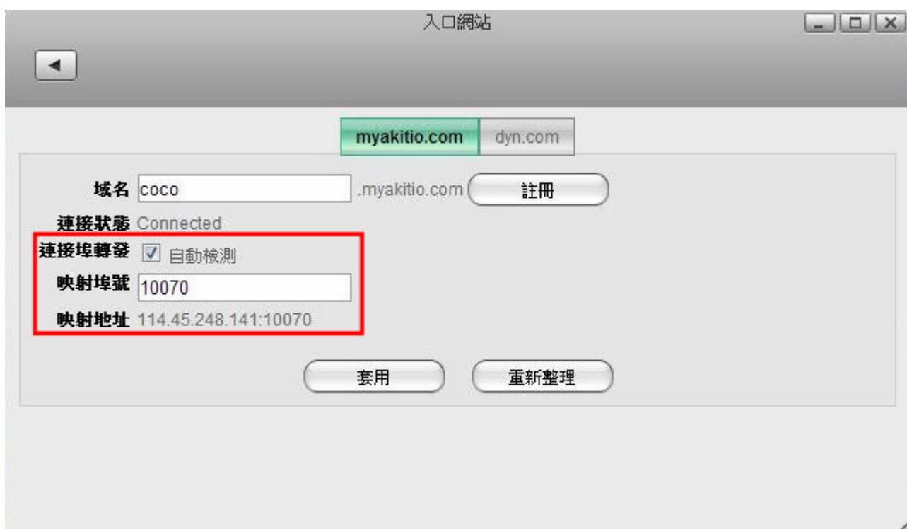
**NAS 所需的連接埠** HTTP連線 (Port:80) 使用瀏覽器操作時所需要的連接埠；VPN (port:9000) 入口網站搜尋您的 NAS 時所需要的連接埠；點對點連接埠 (port:10080或自行設定)：網際網路的環境下，需使用點對點的連線方式時所需要的連接埠。（以上連接埠請務必在您的路由器或是IP分享器內開啟）
