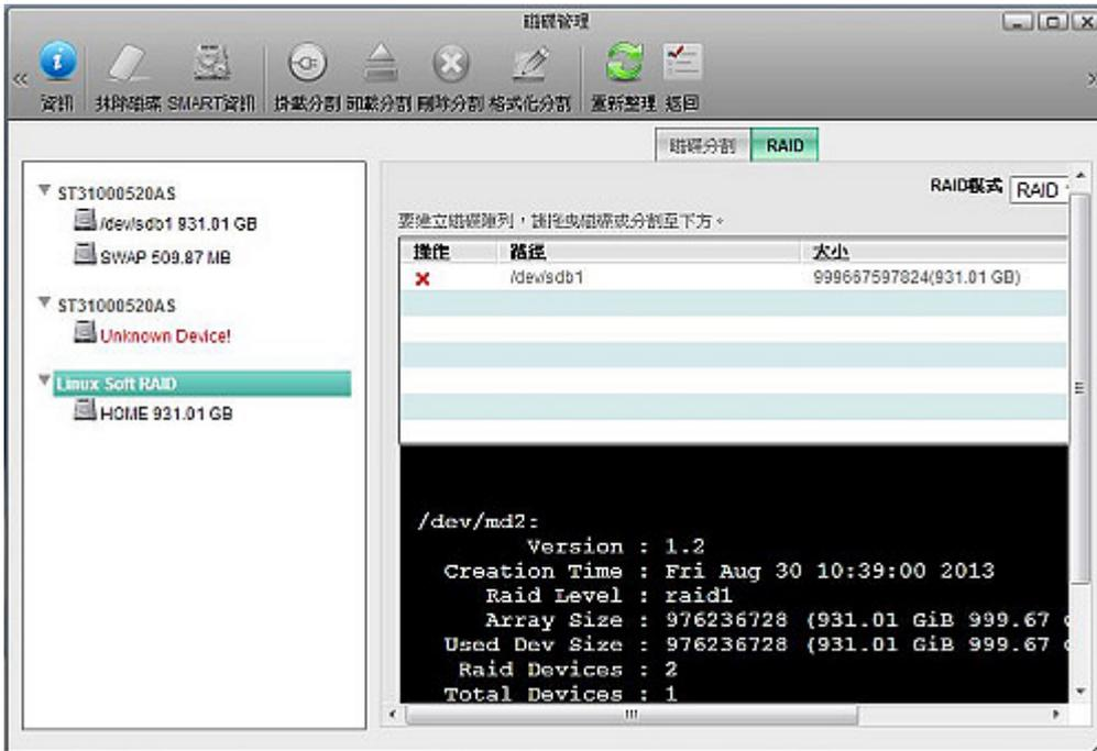
3. 點選「磁碟管理」工具左方視窗的“Linux Soft RAID “，右方視窗選擇” RAID “分頁，然後將滑鼠移至新硬碟的磁碟型號處” ST31000520AS “上方，拖曳置右方視窗中，再按下「重建」按鈕。(在次所使用的是未格式化的磁碟)
