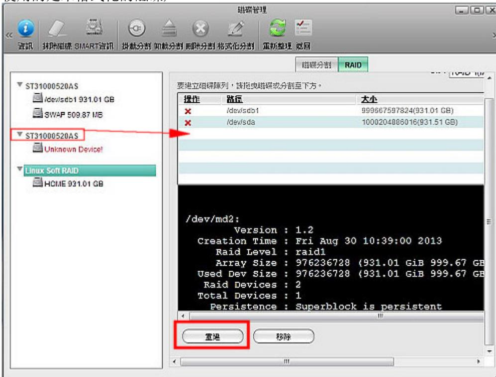
4. 重置動作雖然還在進行，但是您已經可以開始正常使用，不需等到重置動作完成。(您可以在下方圖示處確認重置進度)
