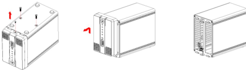
硬碟標籤面相對，推入硬碟插槽中，蓋上前方面板，鎖上底座的前方面板螺絲與硬碟固定螺絲，即完成。
