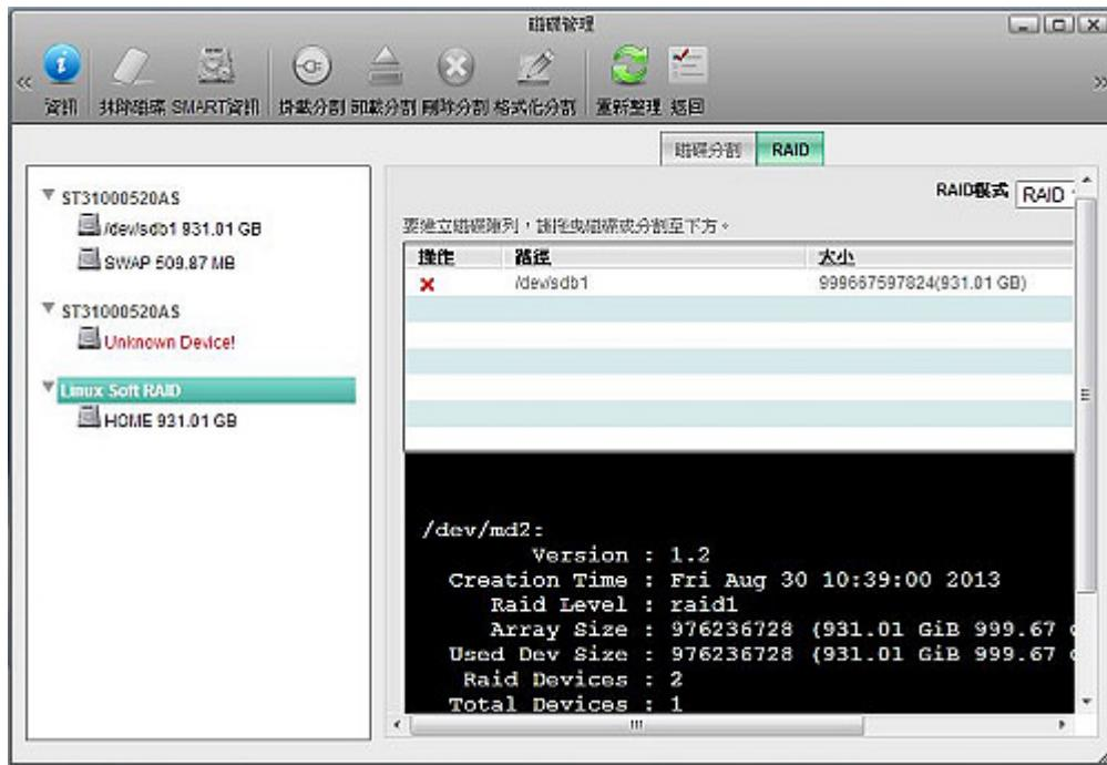
3. 點選「磁碟管理」工具左方視窗的“**Linux Soft RAID**“，右方視窗選擇”**RAID**“分頁，然後將滑鼠移至新硬碟的磁碟型號處”**ST31000520AS**“上方，拖曳置右方視窗中，再按下「重建」按鈕。(在次所使用的是未格式化的磁碟)
