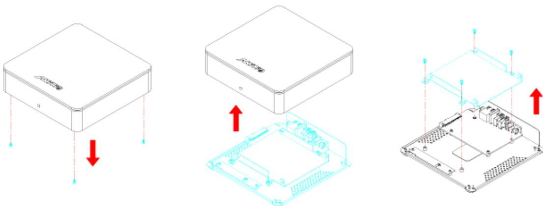
鎖上硬碟固定螺絲，再將支架安裝再底座上，將上蓋向下與底座接合，鎖上底座的四顆螺絲即完成。。
