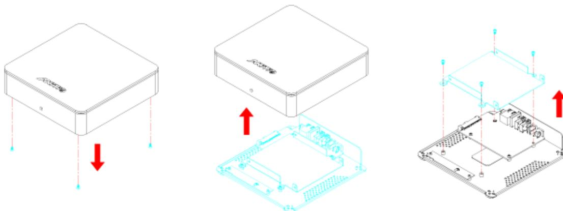
鎖上硬碟固定螺絲，再將支架安裝再底座上，將上蓋向下與底座接合，鎖上底座的四顆螺絲即完成。。
