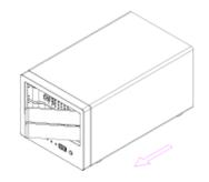
放置硬碟到硬碟抽取匣中,鎖上硬碟固定螺絲,將硬碟抽取匣插回到裝置中,即完成。
